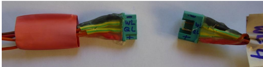
Rumpf links (zum Empfänger) Fläche links Kabel verlötet und mit Schrumpfschlauch überzogen
